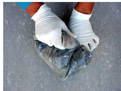
②手で揉み洗いするようにセメントと水溶液を1分程度練り混ぜて下さい。
