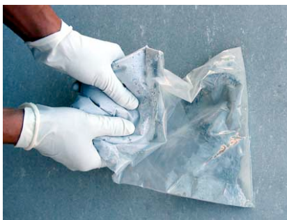
①セメント部を強く握り、水溶液側にセメントを押し出して下さい。
